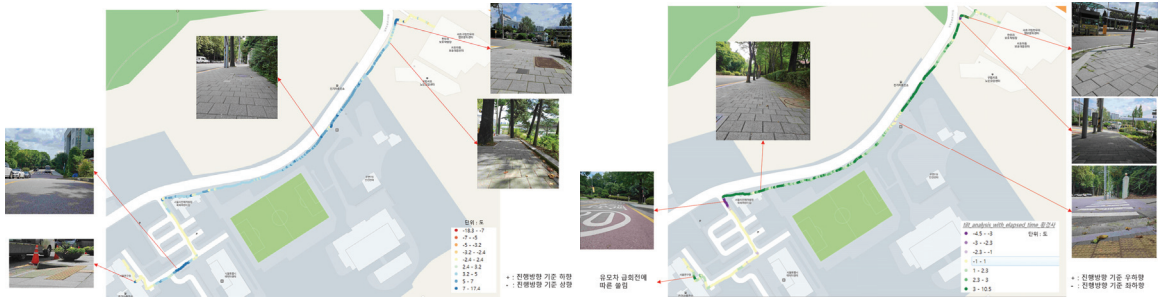
[그림 8] 스마트폰 센서 데이터를 활용한 경사 분석(왼쪽: 중 방향 경사, 오른쪽: 횡 방향 경사)
