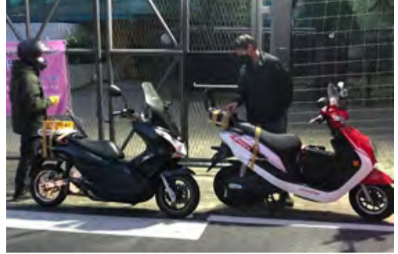
그림 2. 에임스는 대공원 실증을 통해 배터리 충전식(nanu)과 배터리 교환식의 주행거리 효율 차이를 검증. 에임스의 nanu 주행거리가 평균 63.5%로 더 높게 측정됨
