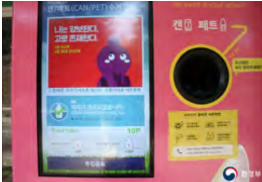
그림 5. 3D 물체인식 기반 폐기물 선별 회수장치인 슈퍼빈의 네프론 활용 모습 (※자료 : 환경부)
