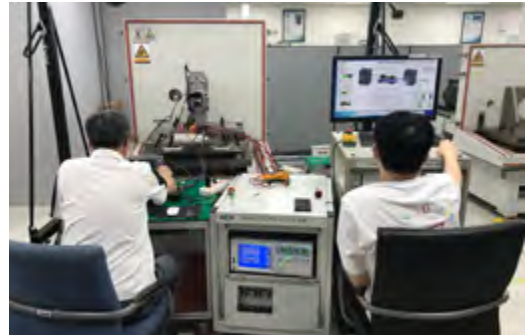
그림 5. 변속기 자체 효율 측정 시험
