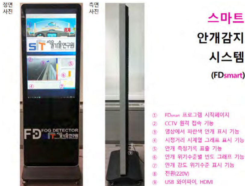
그림 1. 스마트 안개감지시스템(FDsmart) 장치 사진 및 기능
