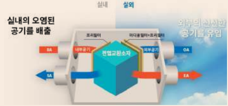
그림 1. 열회수형 환기장치(전열교환기) 구성
