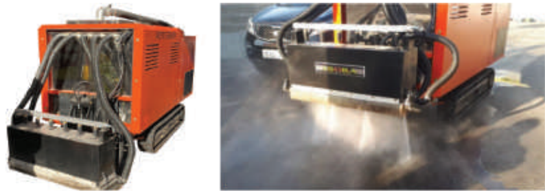
그림 8 | 투수포장 공극회복 장비(고압 살수 및 진공 흡입 방식)
