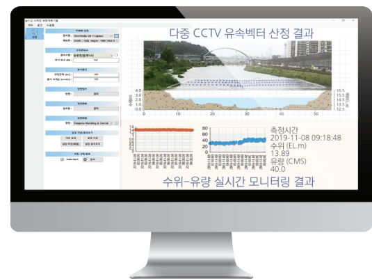
그림 13 | CCTV 기반 자동유량 계측 웹서비스(데모버전)
