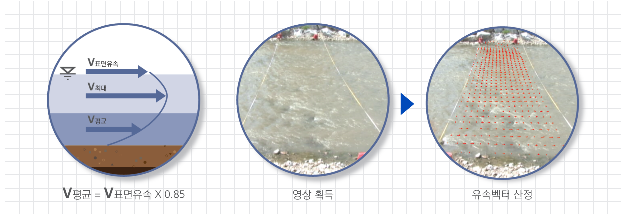
그림 10 | CCTV기반 표면영상유속계를 이용한 유량측정
