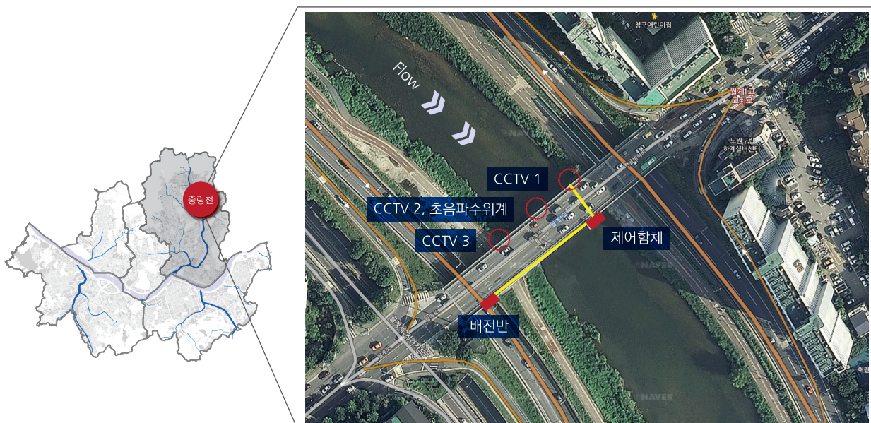
그림 11 | 중랑천(월계1교지점) 유량측정 테스트베드 구축
