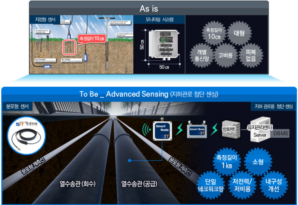
그림 1. 첨단 IoT 기술 기반 열수송관 유지관리 기술 개념도
