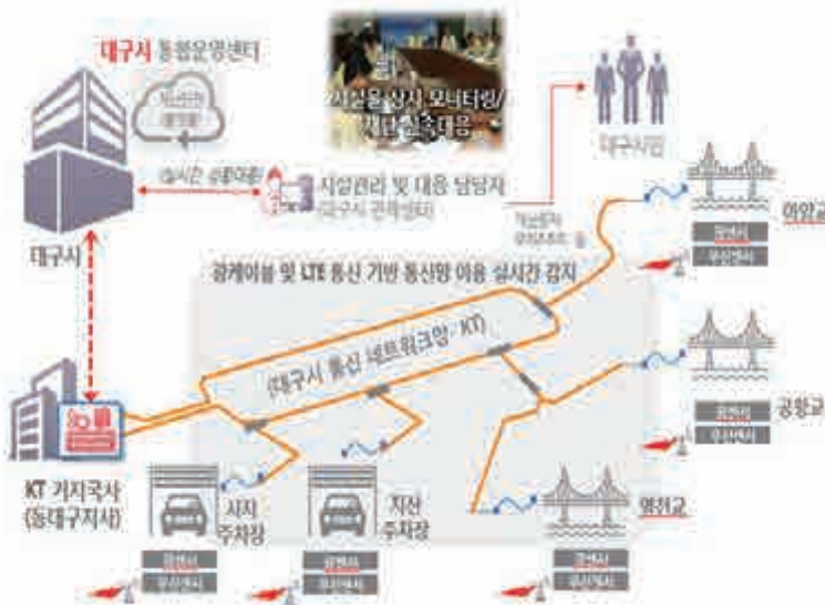
[그림 6] IoT기반 교량·건축물 안전관리 시범사업(대구광역시, 출처 : 한국방송뉴스, 대구시)
